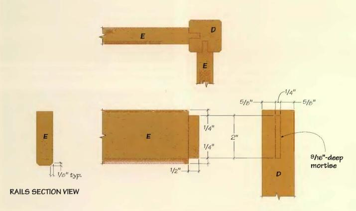
DETAIL: MORTISE & TENON JOINTS (LEG TO RAIL)
